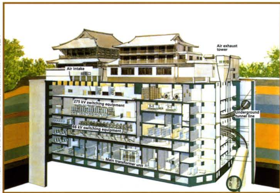
外觀是一座莊嚴華麗的寺廟的高輪變電所，地下七層是變電所設備，是日本最深的地下變電所。
